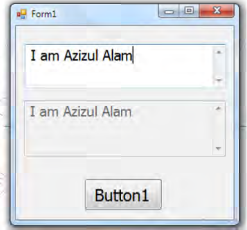
চিত্র-১৩: প্রোগ্রাম Run করে প্রথম টেক্সট বাক্সের লিখা স্বয়ংক্রিয়ভাবে দ্বিতীয়টি লেখা হওয়ার দৃশ্য।
